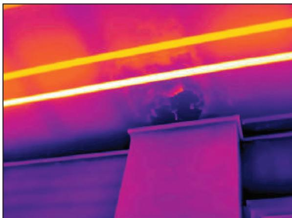
Foto n°1 - Termogramma registrato nella Cucina al piano seminterrato. Porzioni di plafone caratterizzata da infiltrazioni attive.
