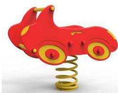
Attrezzatura ludica adatta ai bambini da 0 a 12 anni. Gioco in polietilene riciclabile colorato, con figura doppia, di spessore 19 mm, con mollone colorato in acciaio temperato Ø 200 mm oppure Ø 170 mm anti schiacciamento delle dita garantisce assoluta sicurezza anche in caso di massimo carico. Seduta in polietilene riciclabile in lastra di spessore 20 mm. Telaio metallico da interrare. Maniglie e poggiatesta in polietilene. Attrezzatura gioco rispondente alla EN 1176 / 08 e CERTIFICATA TUV
