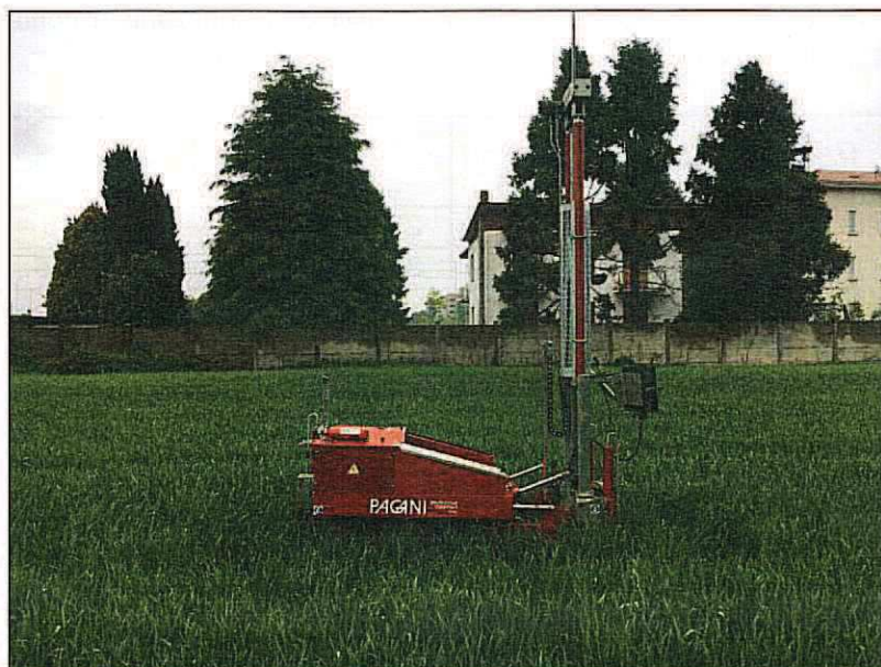
Penetrometro utilizzato tipo Meardi A.G.I.
