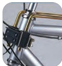
permesso fissare il seggiolino al manubrio. Se applicato anteriormente, deve essere fissato alla parte rigida del telaio della bicicletta e mai alle parti deboli, come il tubo che collega il manubrio al telaio.
