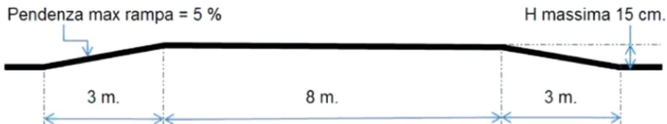
sezione tipo di un attraversamento pedonale con piattaforma rialzata
